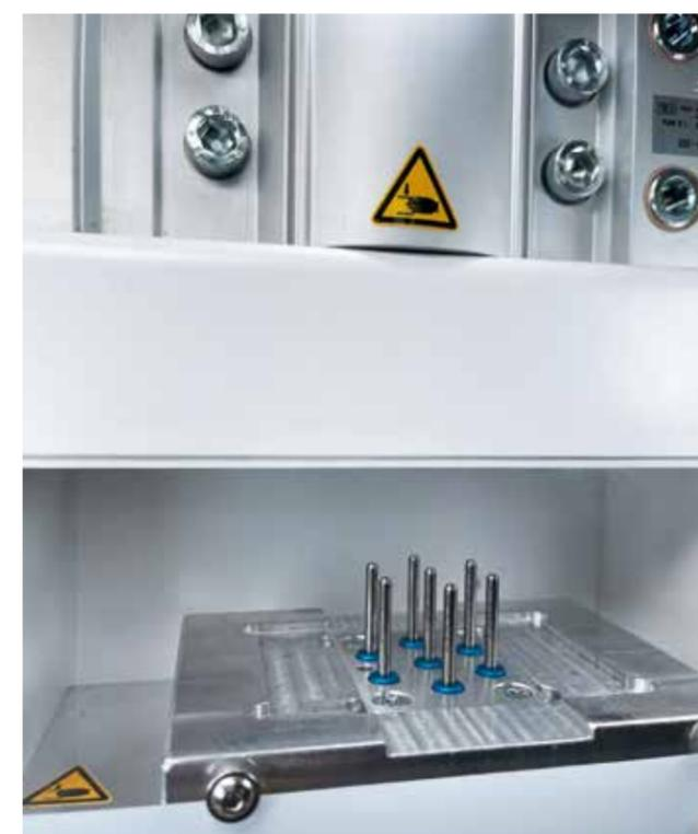
La realizzazione di abutment prefab in titanio richiede che il sistema sia dotato di una particolare precisione. Il sistema DCX ha un sistema di taratura per la fresatura dei prefab che verifica se i supporti sono in posizione corretta garantendo una fresatura sicura e precisa degli abutment. L'elevata precisione, raggiunta grazie a questo speciale processo di taratura, viene ulteriormente
