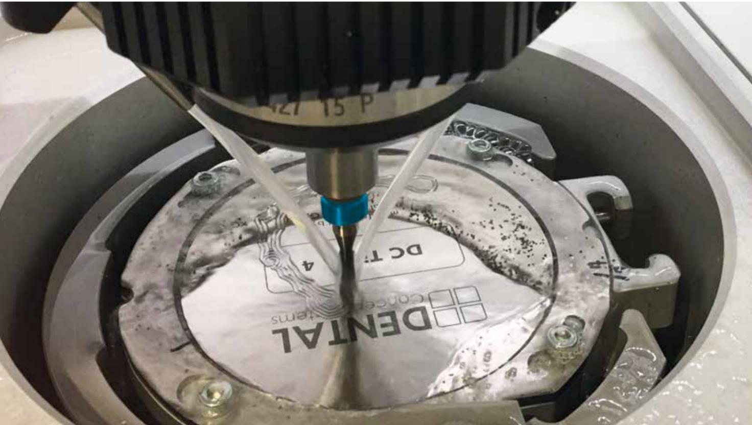
La geometria di taglio e il rivestimento di questi strumenti sono stati studiati in modo specifico per la lavorazione del titanio e con l'ausilio del refrigerante Metall Coolant 014 è possibile ottenere risultati di fresatura estremamente precisi.
