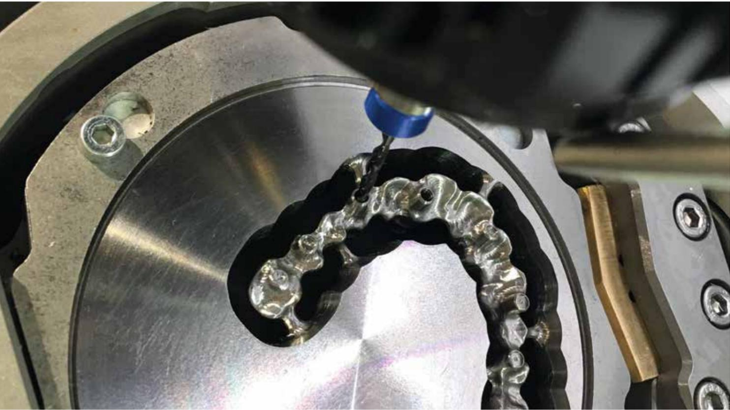
Nella linea BLUE LINE Implant si riflette ancora una volta la grande esperienza dei progettisti DCS. Strumenti, che consentono all'utente di fresare le geometrie implantari direttamente dai blank, sono senza dubbio lo standard qualitativo più elevato. Oltre alle frese a testa tonda, le frese a testa piatta e le frese
