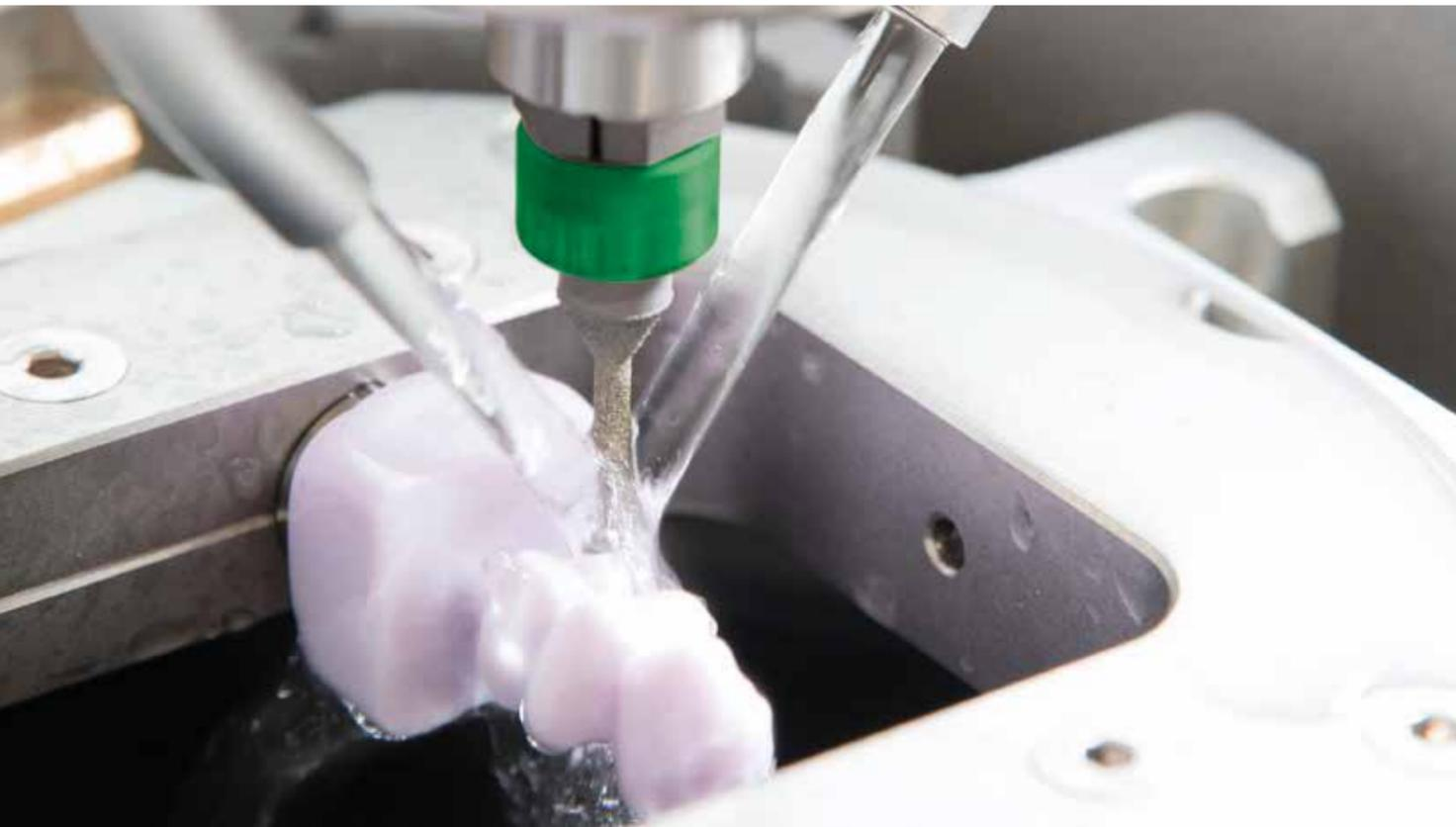
Le frese GREEN LINE, dotate di uno spesso strato di rivestimento diamantato, permettono una lavorazione sicura di tutte le vetro-ceramiche attualmente in commercio nel mercato dentale e sono anche indicate per la rifinitura dei compositi di nuova generazione e delle ceramiche ibride.
