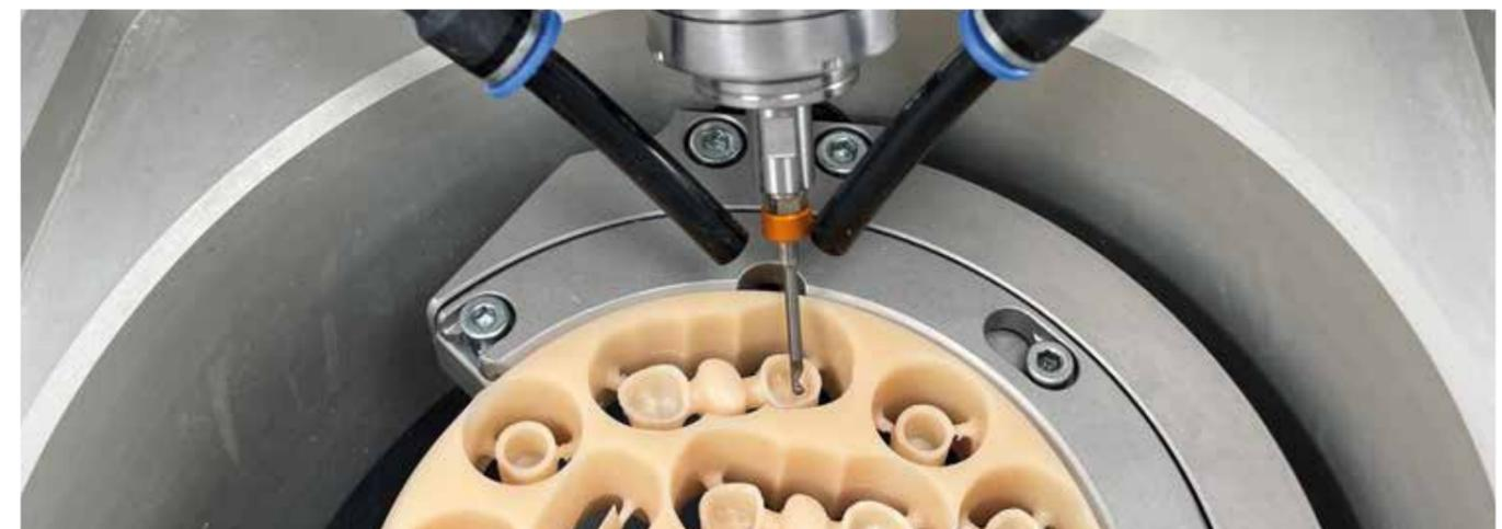
*L'utilizzo di utensili con una maggiore lunghezza utile richiede una strategia che si combini con il software CAM, in particolare per le frese con gambo da 3 mm. La DCS utilizza un software CAM di livello industriale anche per i sistemi DCX!*
